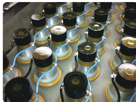
TRANSDUTORES PIEZOELETRICOS DE FABRICAÇÃO PRÓPRIA COM EXCLUSIVO SISTEMA DE APLICAÇÃO - PADRÃO CTA
